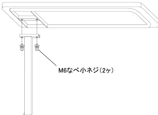
※プラスドライバーで締め付け固定します
