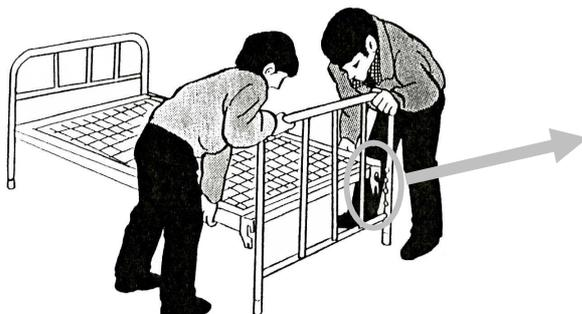
連結はヘッドフットパイプ脚のフックピンに下図のように本体フレームを引っ掛けてください。
