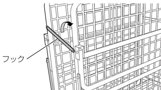
1. ボトム同士を連結している両側のフックを外し、ピンに固定します。
