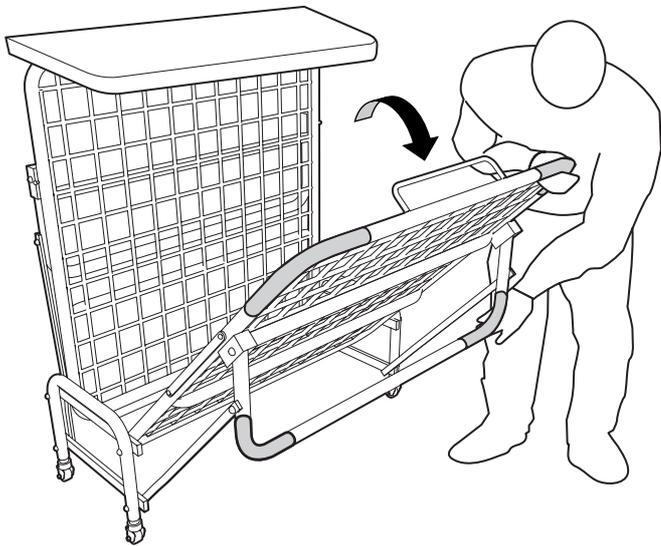
2. 両手で脚パイプとボトムの間(■部分)を持ち、静かに倒します。
