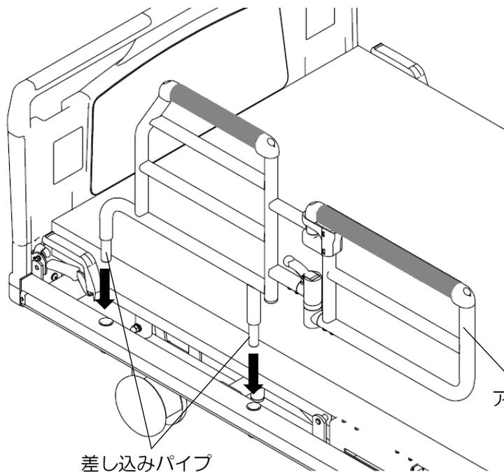
①アームを固定したまま、差し込みパイプをベッドのサイドホルダー(サイドフレーム)の穴へ差し込んでください。
