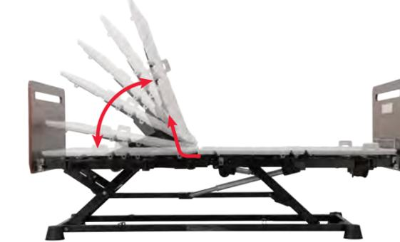
背上げ操作時に、背ボトムがマットレスの厚みを考慮して頭側に押されながら、同時に上へスライドしていく機構を採用しました。『ストレッチラインモーション』は、今まで感じていた背部や腹部への不快な圧迫を解消することができます。
